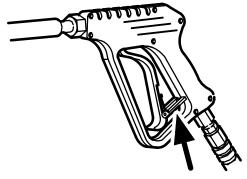
TRIGGER SAFETY LATCH SHOWN ENGAGED
